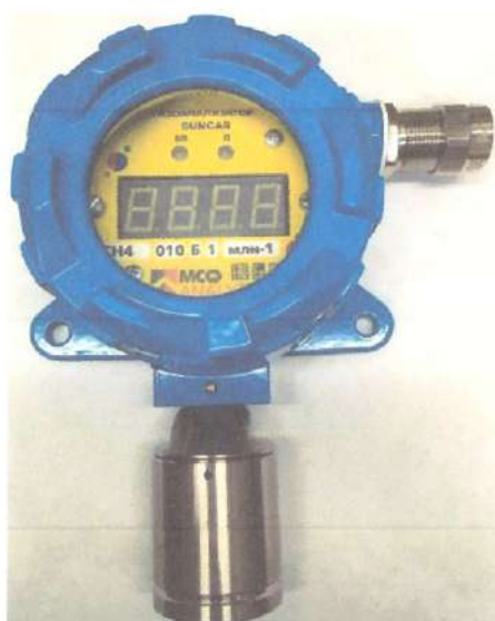
Рисунок 6 – Общий вид газоанализаторов Suncar-XX-XXX-X-X во взрывозащищенном исполнении, в корпусе из алюминия. Исполнение в корпусе «Б»
