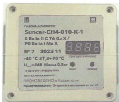
Рисунок 1 – Общий вид газоанализаторов Suncar-XX-XXX-X-X во взрывозащищенном исполнении, в корпусе из алюминиевого сплава с двумя отсеками. Исполнение в корпусе «Г»
